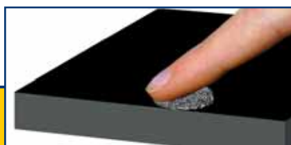
Rouille provenant d'impuretés : La rouille peut même être causée par une simple trace de doigt sur une tôle brute.
