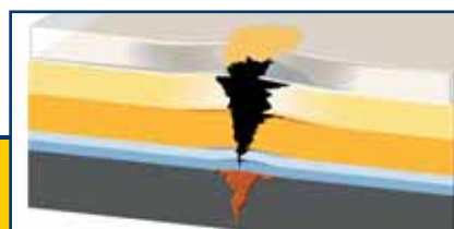
Le sel capte l'humidité du matériau et attire l'oxygène à travers la peinture. Conséquence : la formation de rouille commence sous la couche de peinture.
